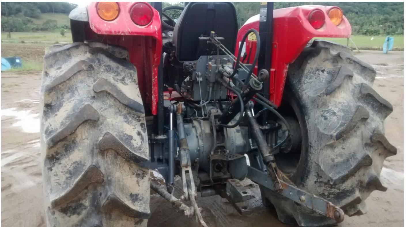
**Verificação do lado de montagem do suporte (lado esquerdo/direito): o suporte tem lado, mas os cilindros hidráulicos, mangueiras, grampos e pinos não tem, são todos intercambiáveis entre si.**
