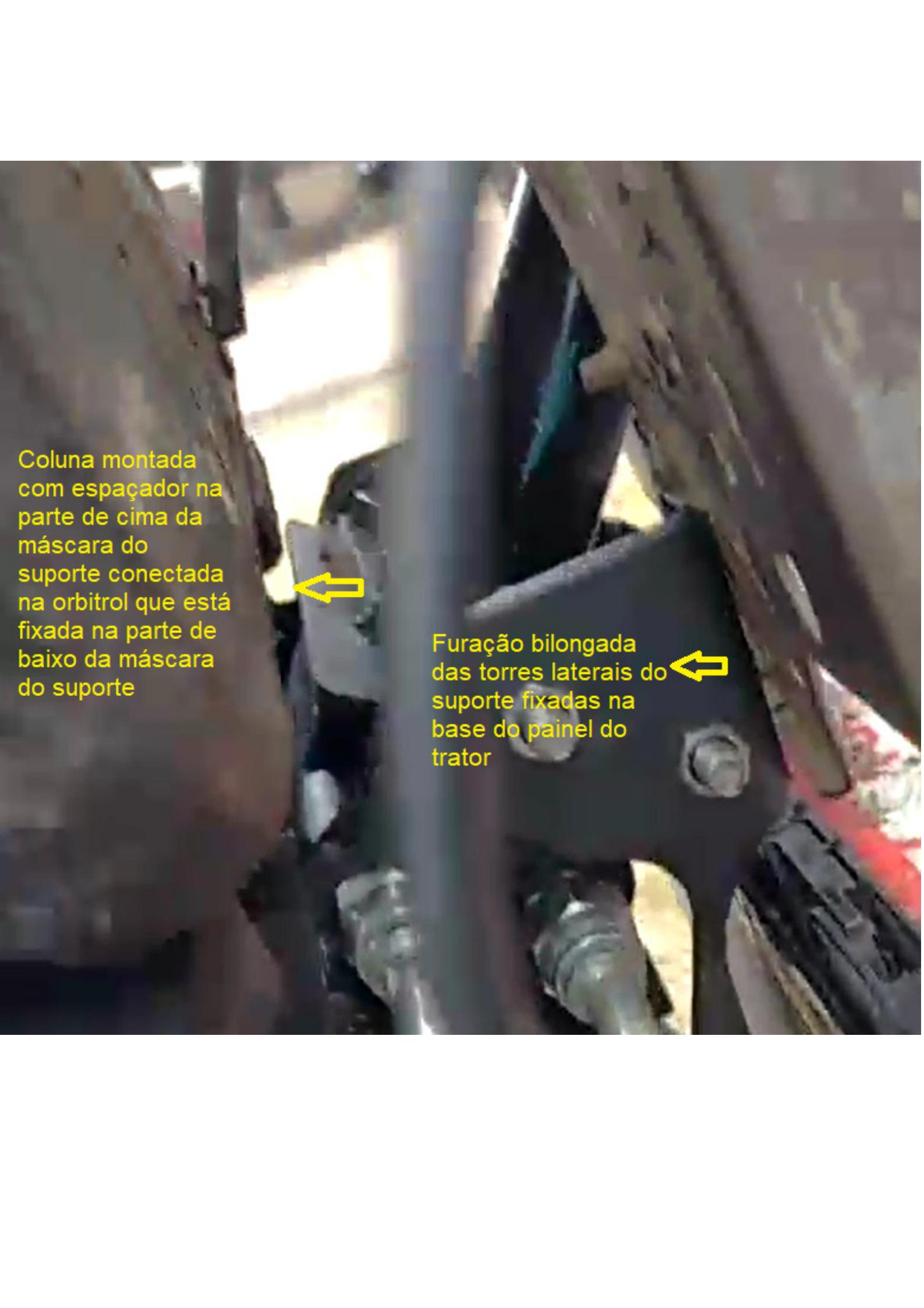
Coluna montada com espaçador na parte de cima da máscara do suporte conectada na orbitrol que está fixada na parte de baixo da máscara do suporte
