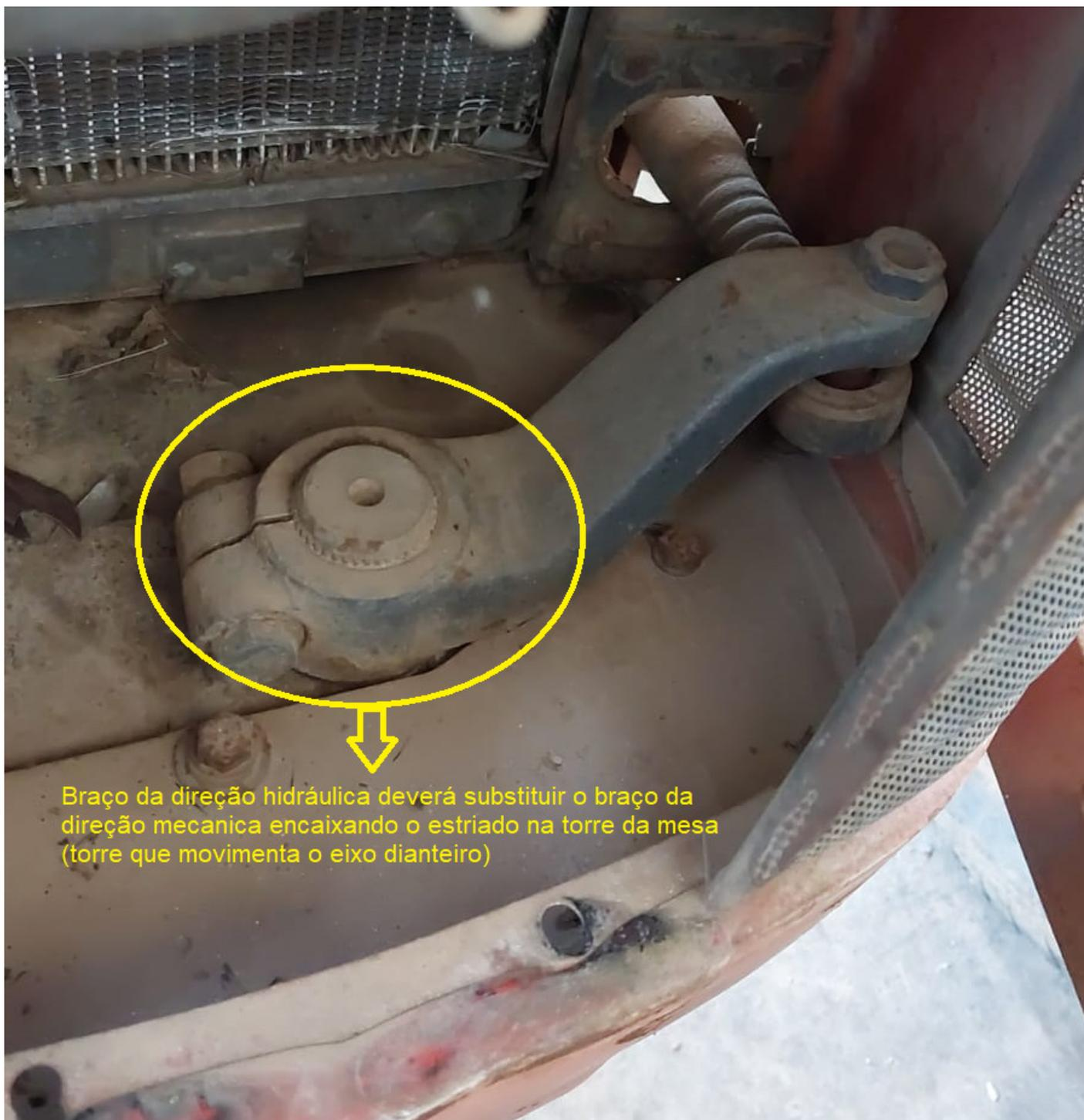
Braço da direção hidráulica deverá substituir o braço da direção mecânica encaixando o estriado na torre da mesa (torre que movimenta o eixo dianteiro)
