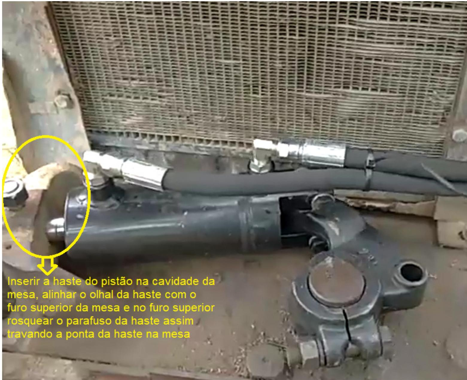
Inserir a haste do pistão na cavidade da mesa, alinhar o olhal da haste com o furo superior da mesa e no furo superior rosquear o parafuso da haste assim travando a ponta da haste na mesa
