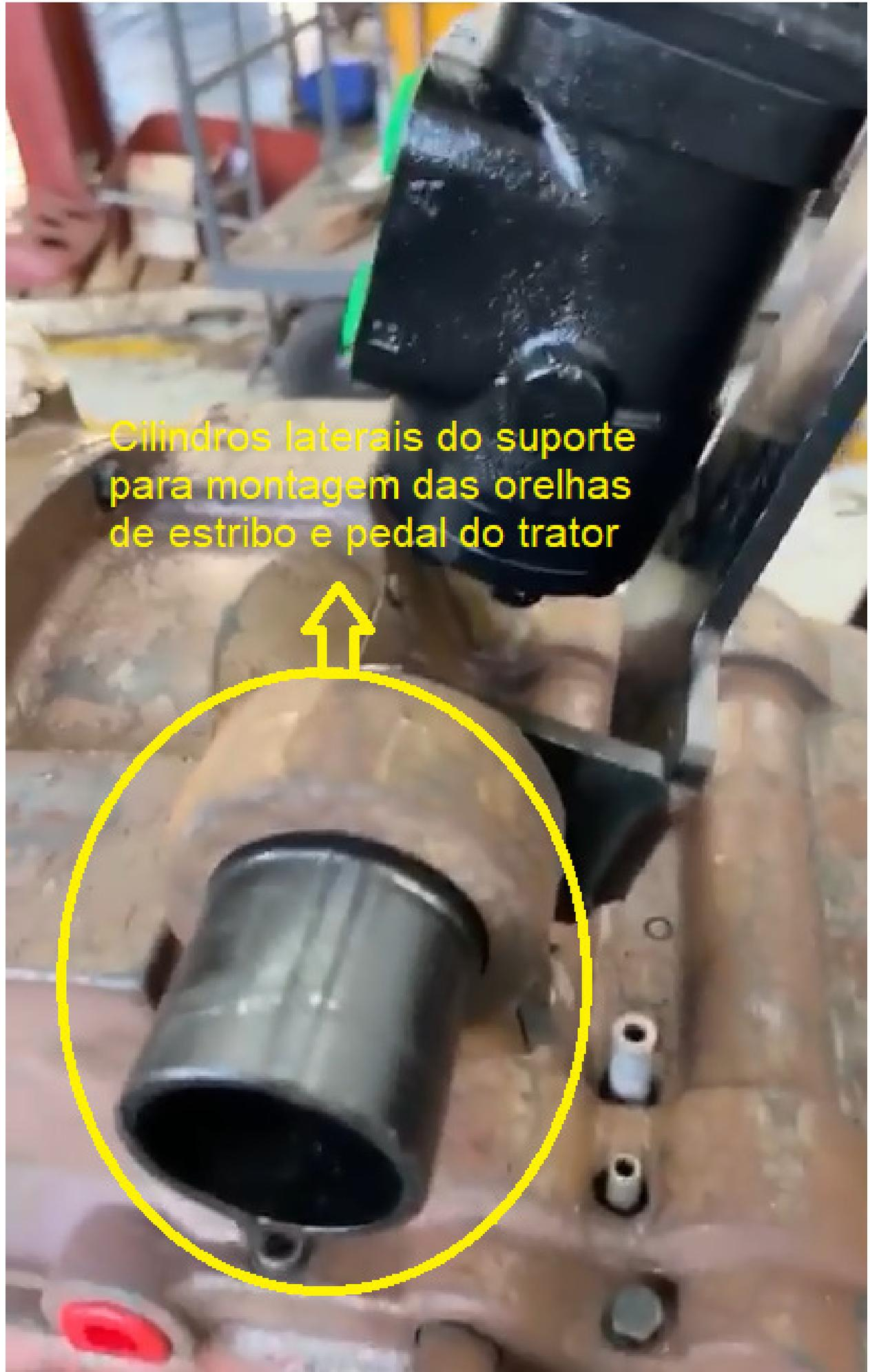
Cilindros laterais do suporte para montagem das orelhas de estribo e pedal do trator
