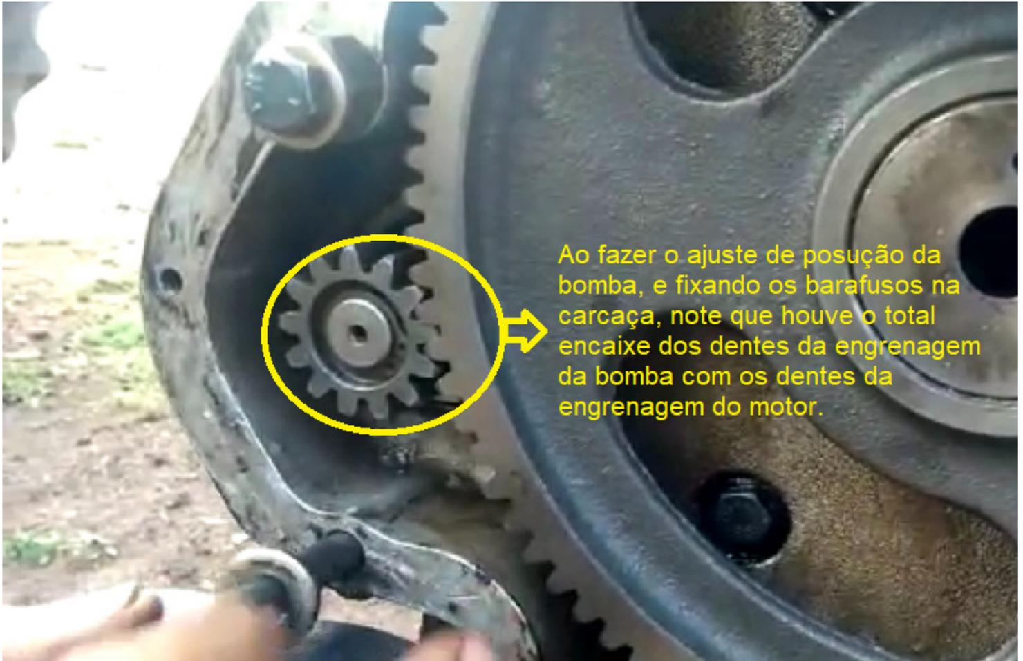
Ao fazer o ajuste de posição da bomba, e fixando os barafusos na carcaça, note que houve o total encaixe dos dentes da engrenagem da bomba com os dentes da engrenagem do motor.
