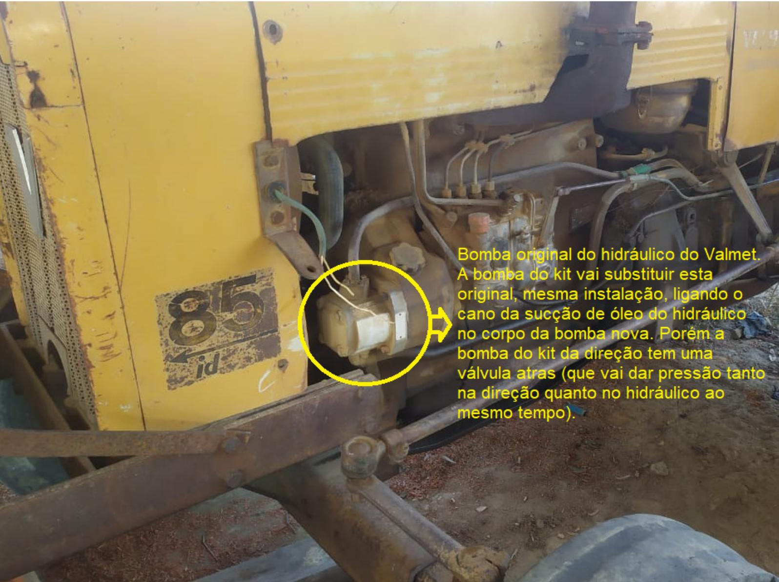
Bomba original do hidráulico do Valmet. A bomba do kit vai substituir esta original, mesma instalação, ligando o cano da sucção de óleo do hidráulico no corpo da bomba nova. Porém a bomba do kit da direção tem uma válvula atrás (que vai dar pressão tanto na direção quanto no hidráulico ao mesmo tempo).
