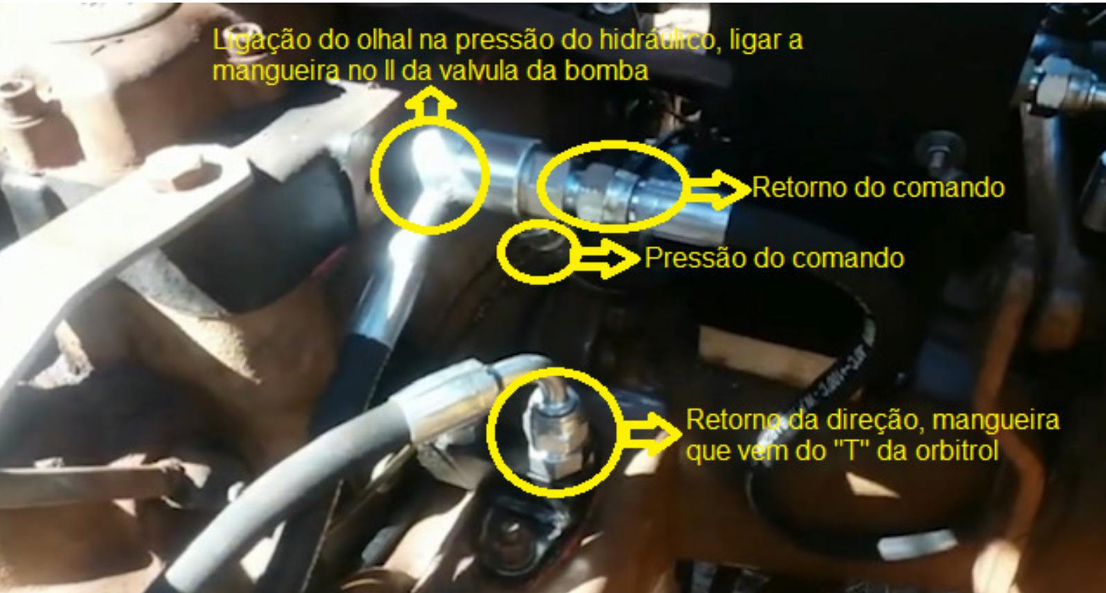
**VISÃO GERAL TERMINAL DE RETORNO DE ÓLEO: retirar o terminal original do trator e fixar o terminal de retorno do kit, ligando conforme abaixo:**
