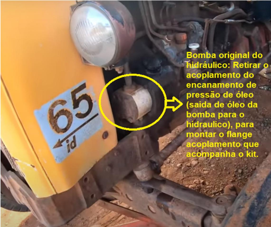
Bomba original do hidráulico: Retirar o acoplamento do encanamento de pressão de óleo (saída de óleo da bomba para o hidráulico), para montar o flange acoplamento que acompanha o kit.
