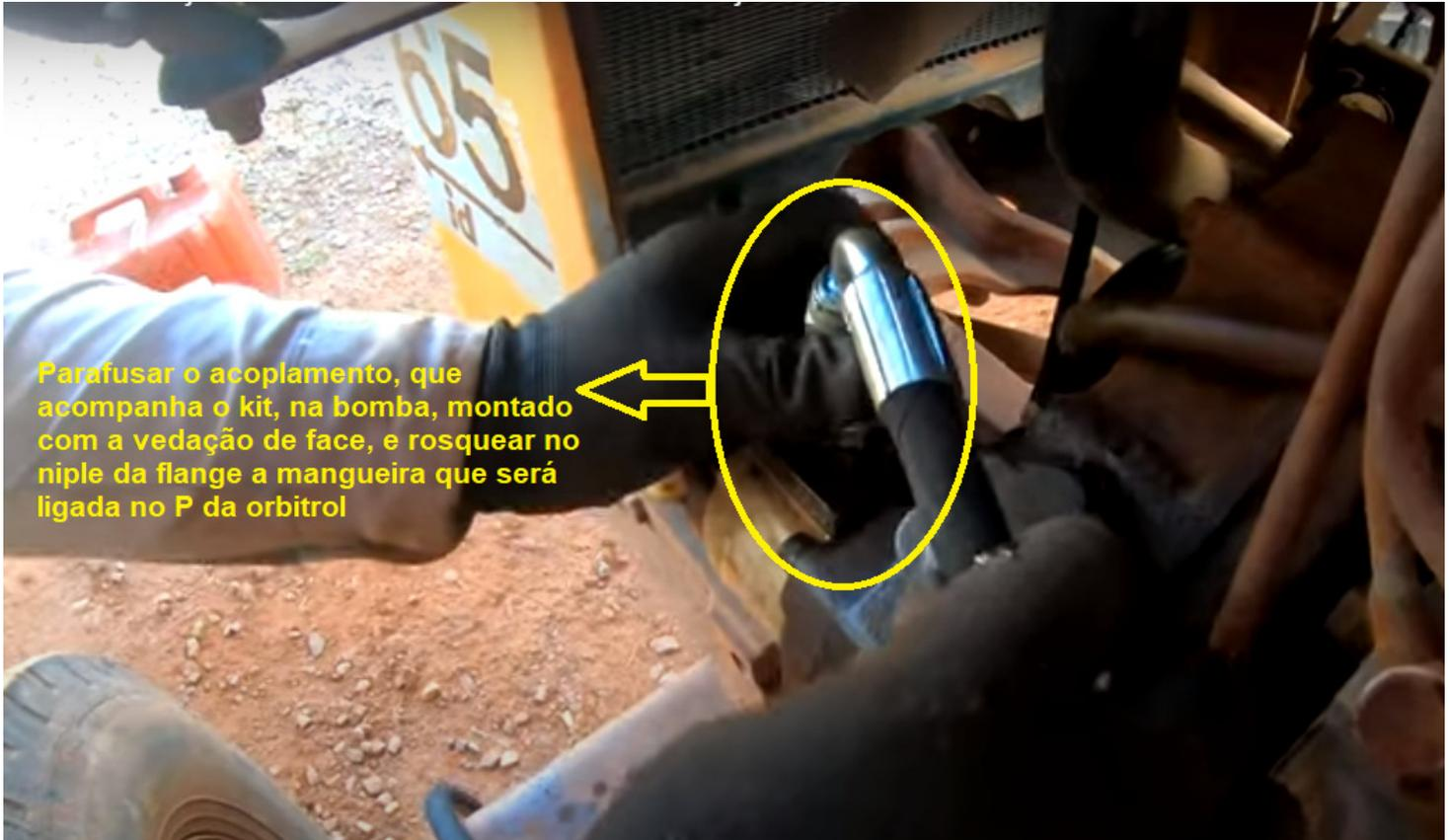
Parafusar o acoplamento, que acompanha o kit, na bomba, montado com a vedação de face, e rosquear no niple da flange a mangueira que será ligada no P da orbitrol
