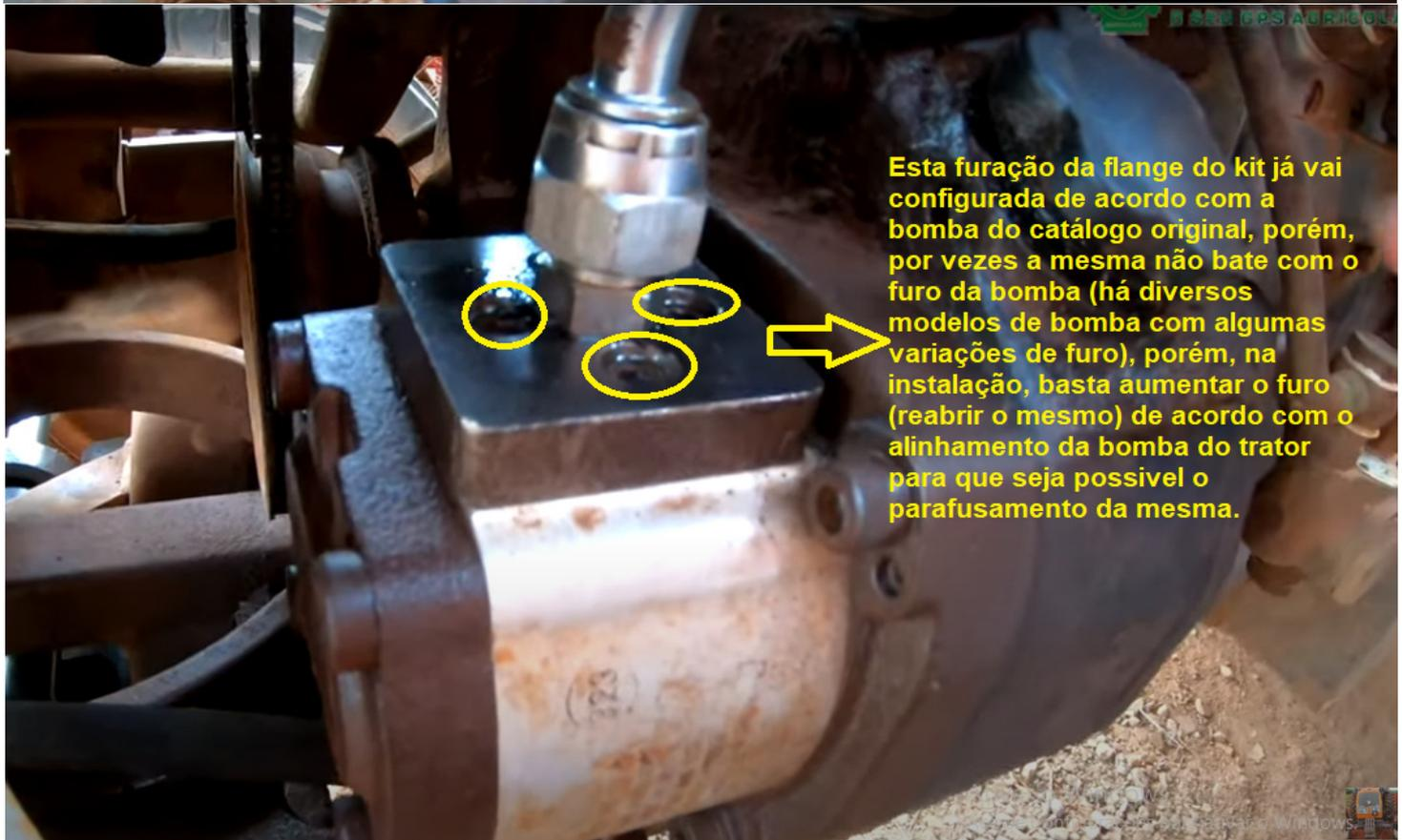
Esta furação da flange do kit já vai configurada de acordo com a bomba do catálogo original, porém, por vezes a mesma não bate com o furo da bomba (há diversos modelos de bomba com algumas variações de furo), porém, na instalação, basta aumentar o furo (reabrir o mesmo) de acordo com o alinhamento da bomba do trator para que seja possível o parafusamento da mesma.
