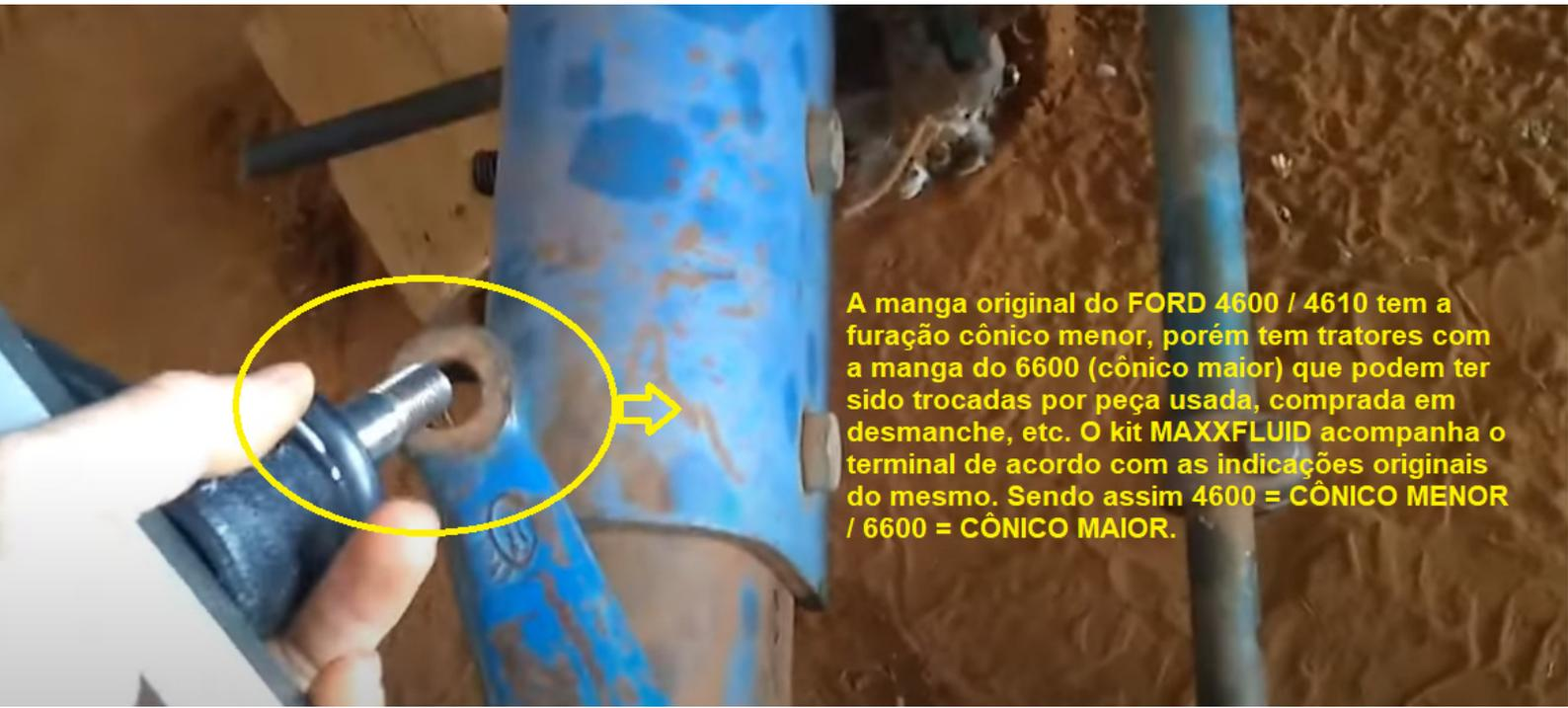
A manga original do FORD 4600 / 4610 tem a furação cônico menor, porém tem tratores com a manga do 6600 (cônico maior) que podem ter sido trocadas por peça usada, comprada em desmanche, etc. O kit MAXXFLUID acompanha o terminal de acordo com as indicações originais do mesmo. Sendo assim 4600 = CÔNICO MENOR / 6600 = CÔNICO MAIOR.
