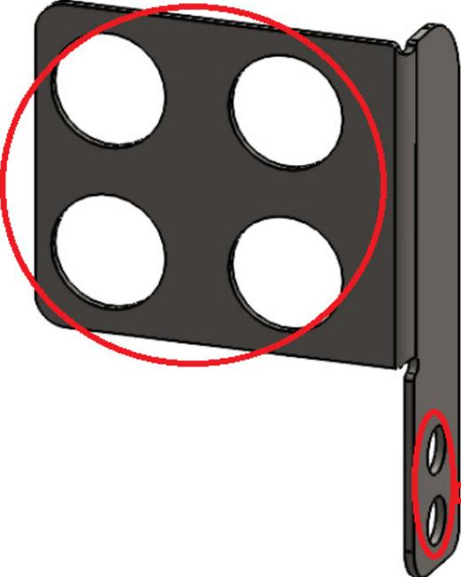
Furação para fixação deste suporte na porção traseira do paralamas lateral do trator. Fazer a furação do paralamas onde desejar e fixar com os parafusos
