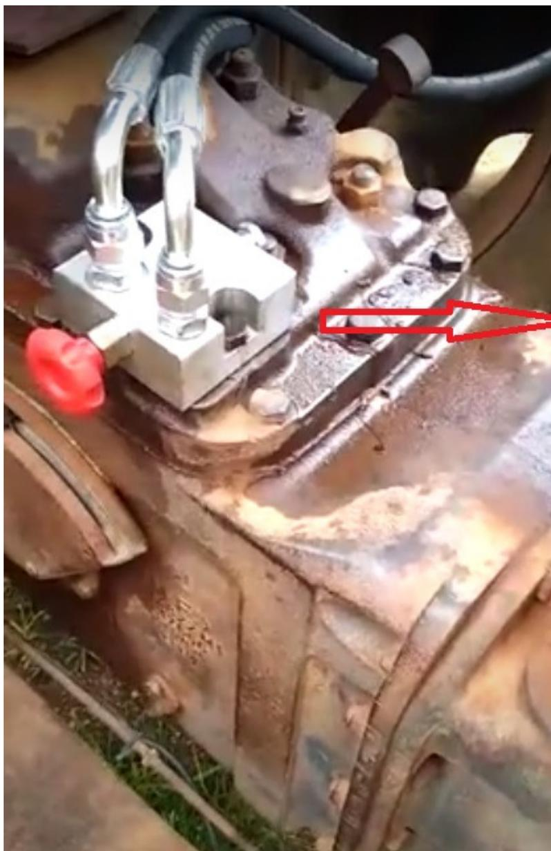
**Retirar a tampa do bloco do hidráulico para saída de encanamento da bomba do hidráulico traseiro. Conectar o cano da bomba no pórtico central da válvula. Fixar novamente no bloco com o cano encaixado na bomba e com os parafusos originais da tampa.**
