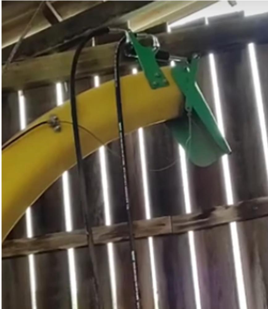
**ACOPLAR AS MANGUEIRAS COLOCANDO A VALVULA DE CONTROLE DE FLUXO NA MANGUEIRA DE PRESSÃO PARA CONTROLAR A VELOCIDADE DE ABERTURA E FECHAMENTO DA TAMPA.**
