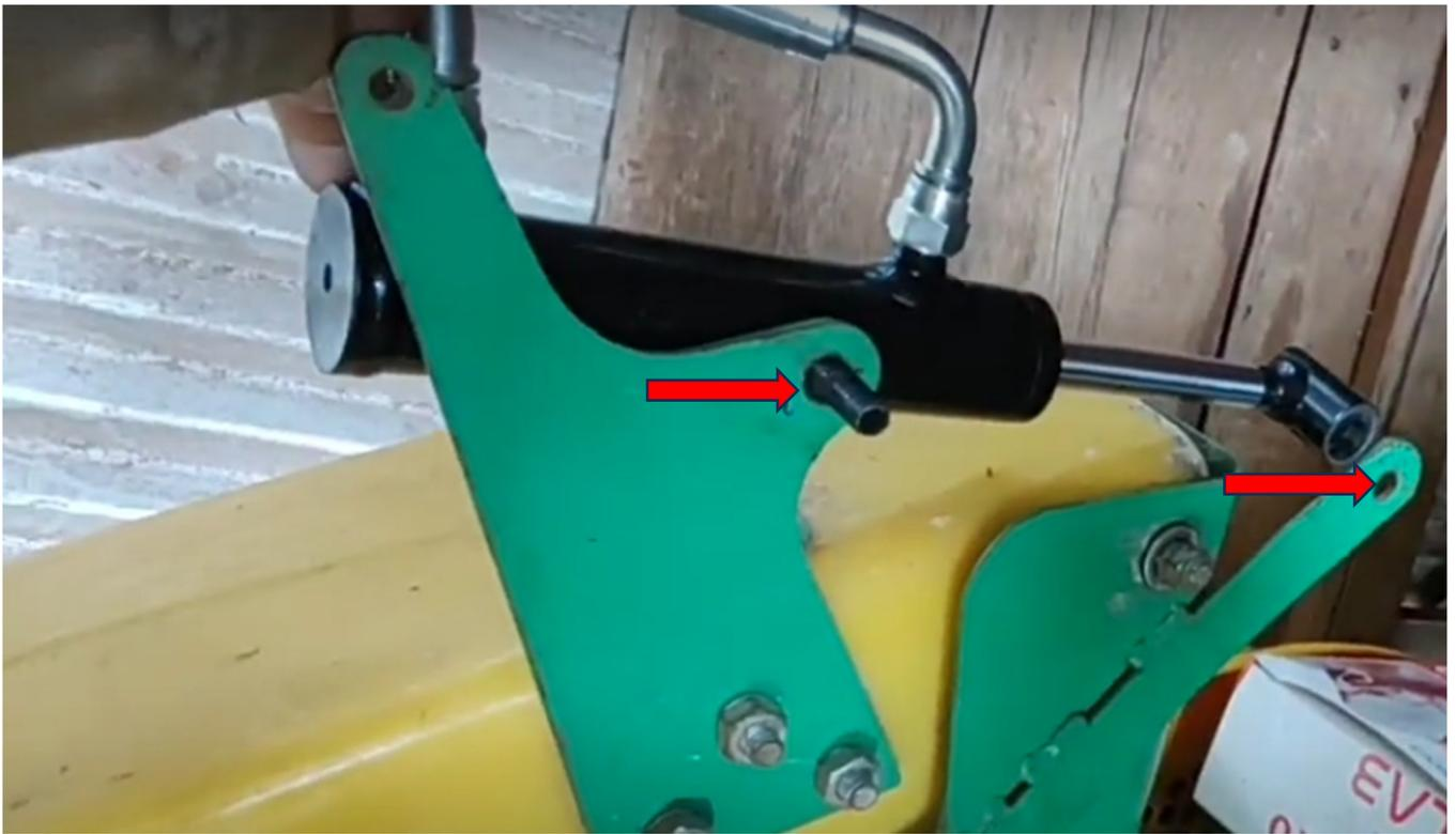
Alinhar a haste aberta do pistão ao furo do suporte original para fixar com parafuso, e inserir o parafuso do corpo do pistão na furação do suporte superior original.
