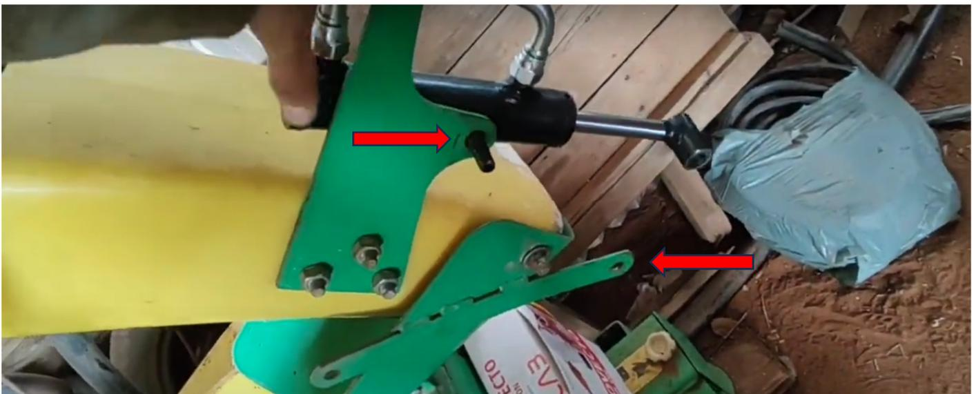
Retirar a catraca original á cabo para liberação dos pórticos para a fixação do pistão do kit
